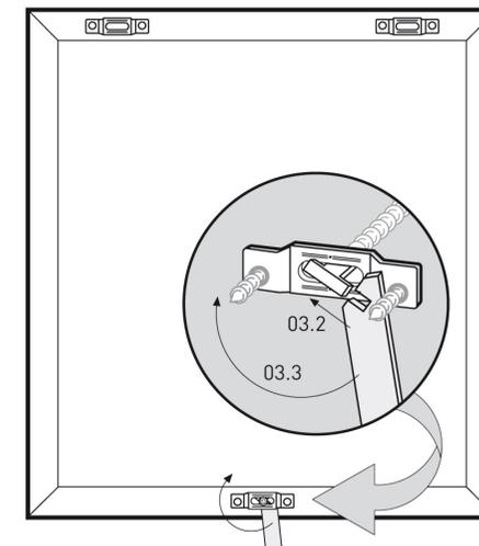
Die Spezialbeschläge (1) wie oben abgebildet mit Linsenschrauben (2) auf den Holzrahmen schrauben.
